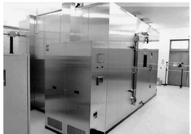
21 m 3 大形チャンバー試験室 (NITE北陸支所)
