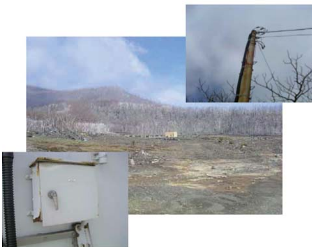
図1 三宅島硫黄化合物の通信設備への影響
